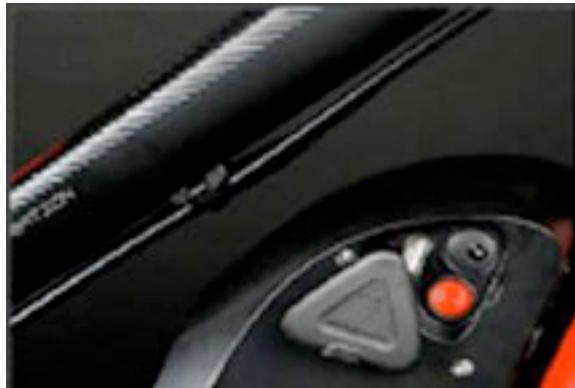
Порт питания батареи расположен под пластиковой треугольной крышкой. Здесь же располагаются кнопка включения и USB-порт.
